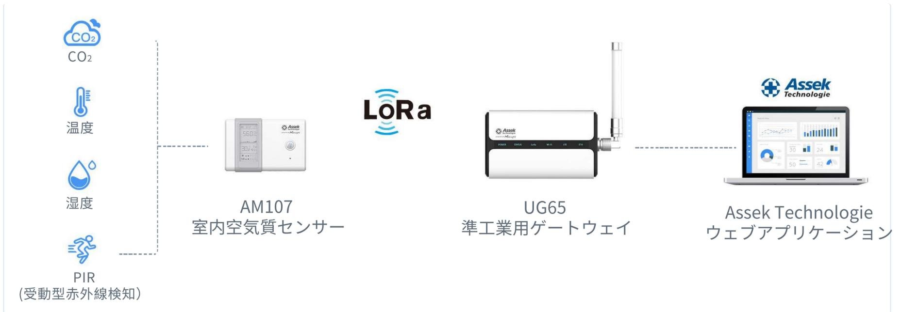
\*室内空気環境センサーAM107は、TVOC、照明、気圧もモニターできます。
