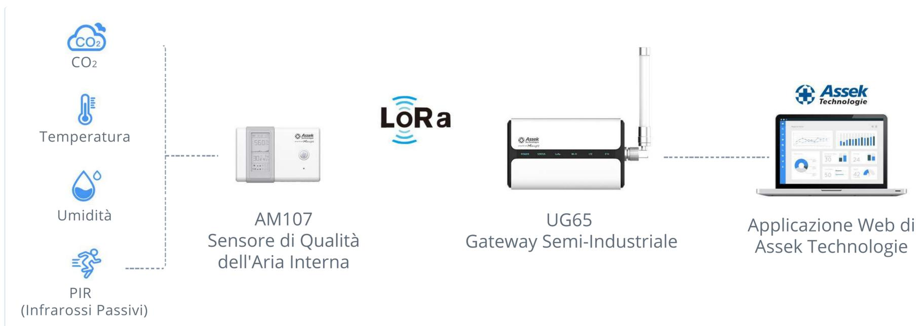
\*Il sensore di qualità dell'aria interna AM107 può anche monitorare TVOC, Luce e Pressione Barometrica.
